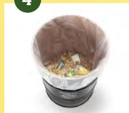
Mettere nel fusto un primo strato di vermiculite. Sistemare nel fusto gli accumulatori Li-ioni e le pile-Li, già messi in sicurezza contro possibili cortocircuiti, in modo tale che non si tocchino e contornarli con vermiculite.
