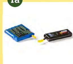
Coprire accuratamente i poli dei singoli accumulatori Li-ioni e pile-Li con nastro adesivo per evitare possibili cortocircuiti.
