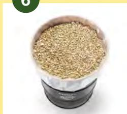
Dopo l'ultimo strato di accumulatori Li-ioni e di pile-Li, ricoprire nuovamente il tutto con vermiculite.
