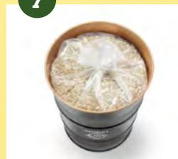
Richiudere ora a tenuta stagna l'inliner (p.es. con una fascetta). In un fusto non completamente riempito richiudere sempre l'inliner con una fascetta! (Questo eviterà movimenti e/o fuoriuscite degli accumulatori Li-ioni e delle pile-Li.)
