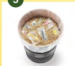
Su ogni strato di accumulatori Li-ioni e di pile-Li versare un nuovo strato di vermiculite. Ripetere questa procedura fino a quando il fusto è riempito.
