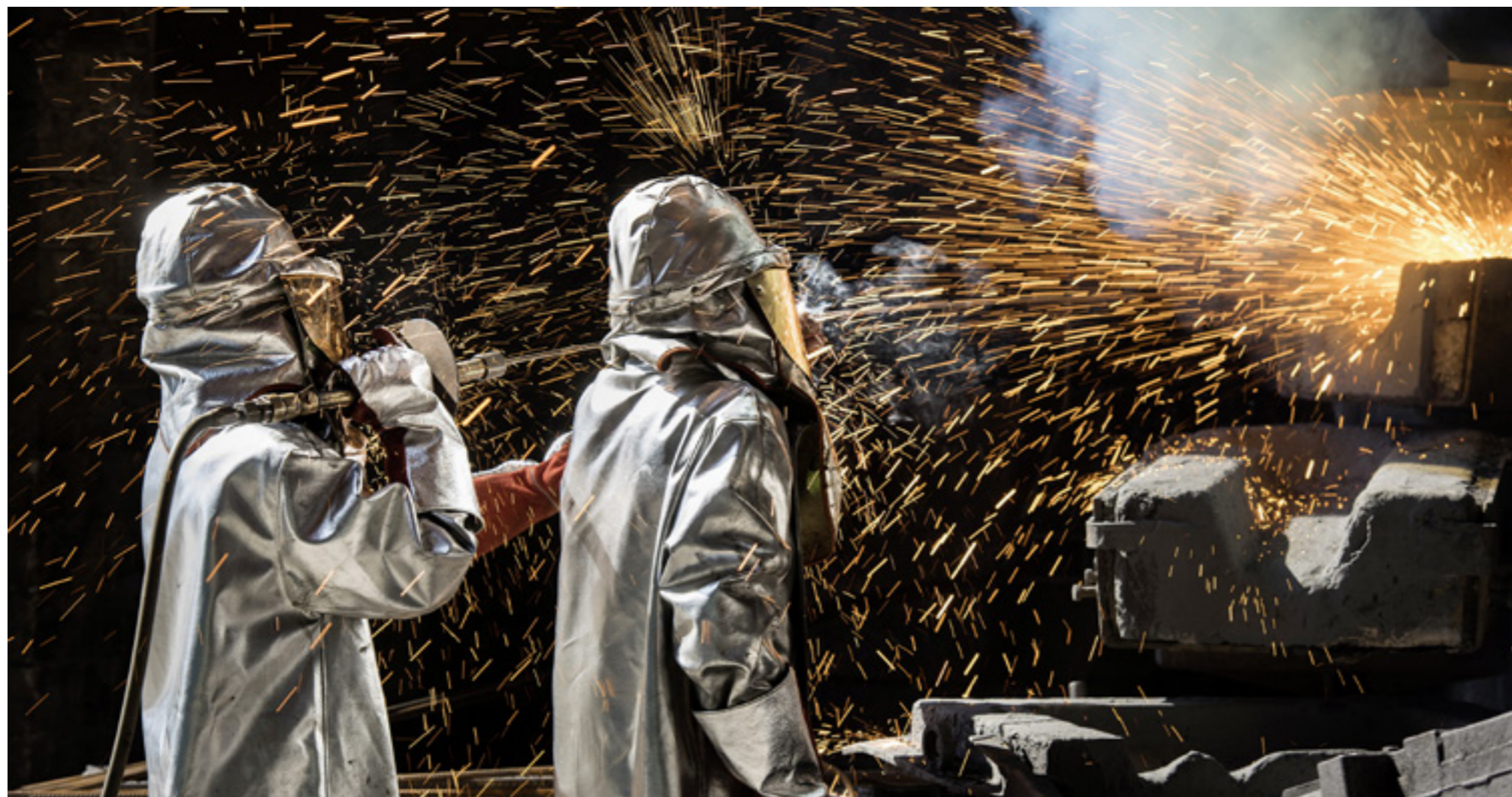
«Perforare» con una lancia a ossigeno la massa contenente ferromanganese, ottenuta dopo la fusione delle pile usate, è un lavoro che rompe la schiena. (Foto: David Schweizer)
