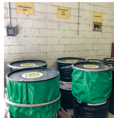
Batterien werden in den INOBAT-Fässern gelagert: getrennt nach Lithium-Batterien und Gerätebatterien.
