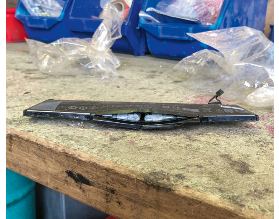
Geblähte Laptop-Akkus sind kein seltenes Bild in Zerlegebetrieben. Um einer Entzündung vorzubeugen, werden die Pole abgeklebt und die Akkus in Plastiksäcke verpackt.
