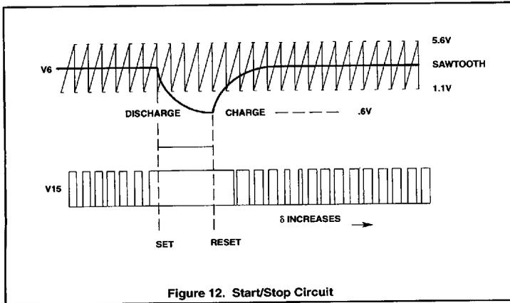
Figure 12. Start/Stop Circuit
